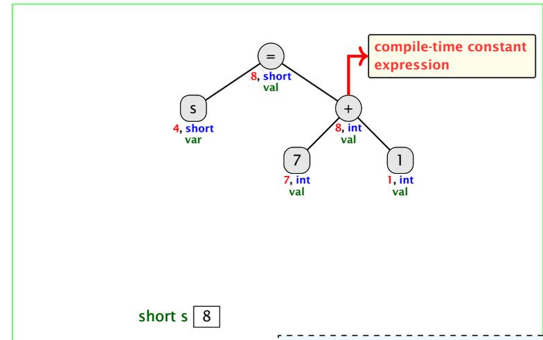
Wenn der `int`-Ausdruck, der zugewiesen werden soll, zu Compilerzeit bekannt ist, und er in einen `short` „passt“, wird der Cast von `int` nach `short` durchgeführt.
